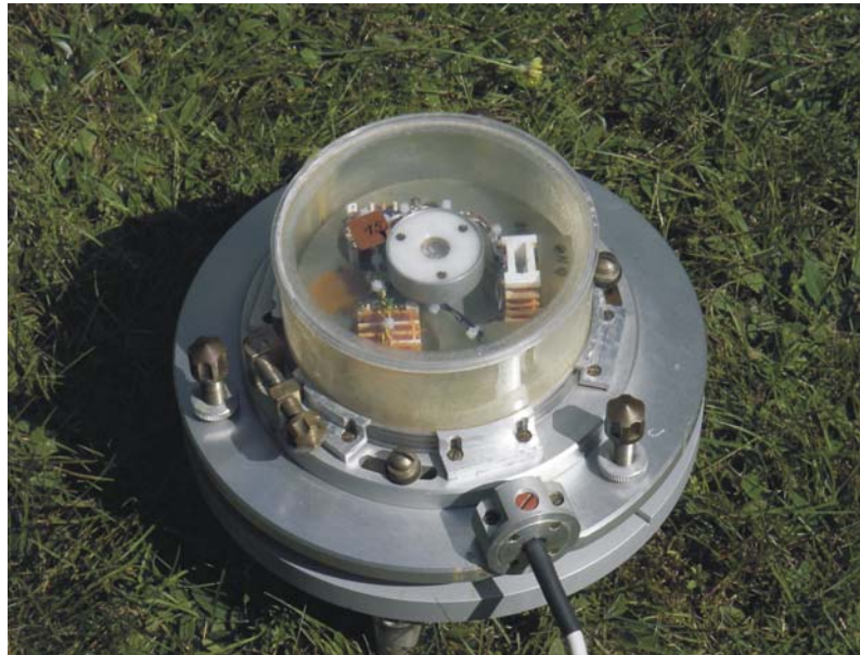
Abb. 1 MAGSON 3 axial fluxgate Magnetometer Baujahr 1993
